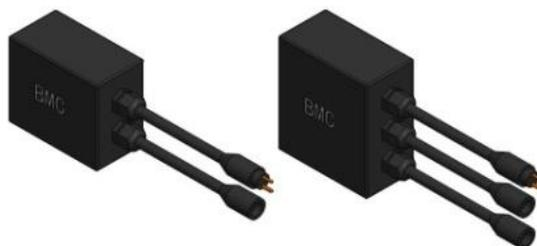
使用符合 FAA 150-5345-26 标准的连接器（2 芯插头和插座）安装在灯箱内隔离变压器二次侧和灯具之间，用于在线检测灯泡状态，并通过电力线载波通讯方式接收并执行来自 CCU 的命令（查询/开/关等），响应灯泡的状态信息；
